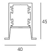
Profilo in alluminio estruso verniciato bianco opaco, adatto all'installazione ad incasso a scomparsa totale nel cartongesso. Predisposto per l'alloggiamento all'interno di strisce LED, consente un effetto luce continuo ed omogeneo. Grazie al diffusore in policarbonato satinato retratto di 14mm rispetto al bordo inferiore, determina una migliore resa estetica.
